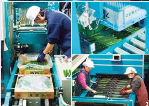
1.良質なキュウリを選別して自動で箱詰め。2.ダンパーを導入して、箱から優しくひっくり返せるようになりました。これでイボを残したまま出荷できます。3.青い箱の中がカメラ。傷があるキュウリは人の目でもチェックします。4.箱詰めの仕上げ。表示の重さより多く入るよう入れ足します。
