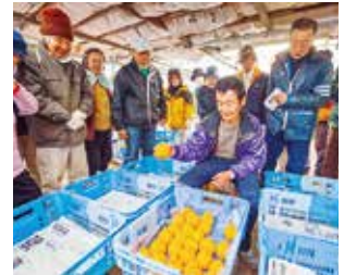
コンテナの1玉を手で持つと引き算をして「2L」「3L」としゃべってくれる賢い秤。選別作業はサクサクと進みます。
