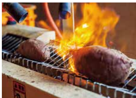
ヒゲ根を焼き切る機械。うぶ毛のような根が一瞬、真っ赤に燃え上がって。
