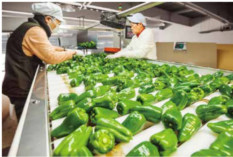
上/1個ずつの計測データを正確に計量するセンサー。年間約1700トンを出荷します。左/レーンの両側から2人ずつ手作業でならし、欠点のある実を除いていきます。このあと透過装置へ。
