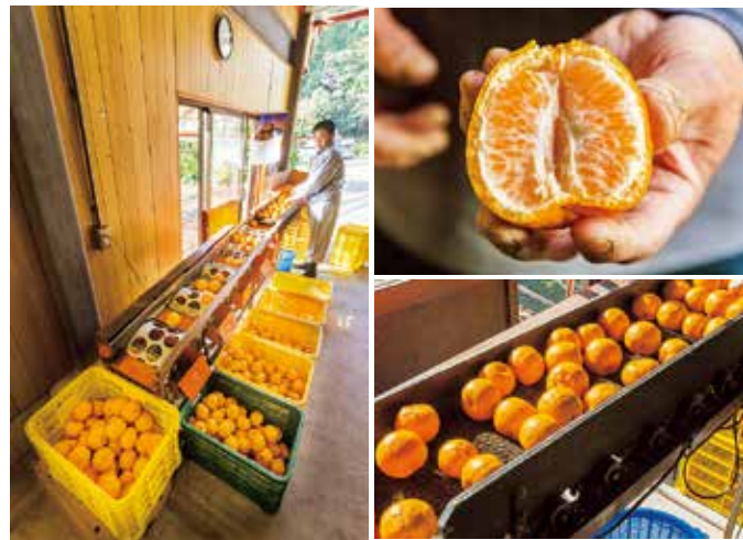
選果機で6等級に分け、回る間にブラシが磨き、ツヤを出します。
